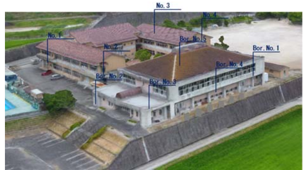
図-1 ドローン画像による学校敷地内の3次元点群データ
