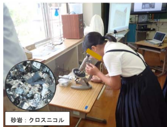
写真-3 偏光顕微鏡による薄片試料観察の様子
