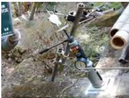
写真-7 ボルトジャッキ試験状況
