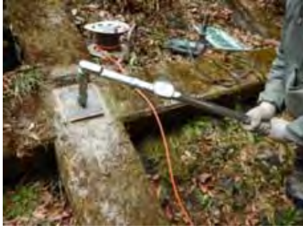
写真-6 トルクレンチ測定状況
